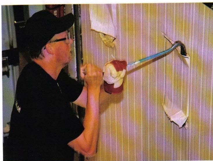
Lars Isaksson från SSF Provningsavdelningen testar den första inbrottskyddade väggen. FOTO JAN-PETER ALM
